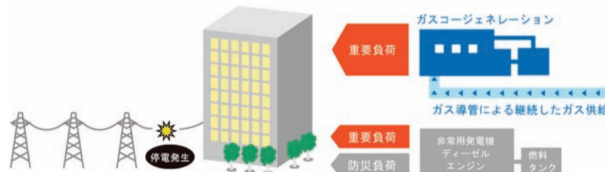
図3 停電時のCGSによる電力供給
